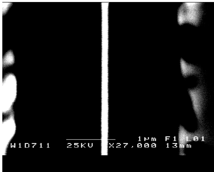
FIG. 4.18 – Image par microscopie électronique d'un FET, doté d'une grille de longueur 0.2\mu\text{m} environ.
