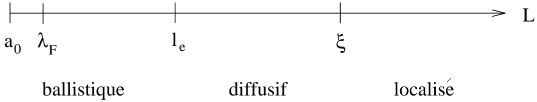
FIG. 1.7 – Les différentes échelles de longueur dans le régime mésoscopique. a_0 est le rayon de Bohr, \lambda_F la longueur d’onde de Fermi, l_e le libre parcours moyen élastique, \xi la longueur de localisation, L la taille de l’échantillon.
